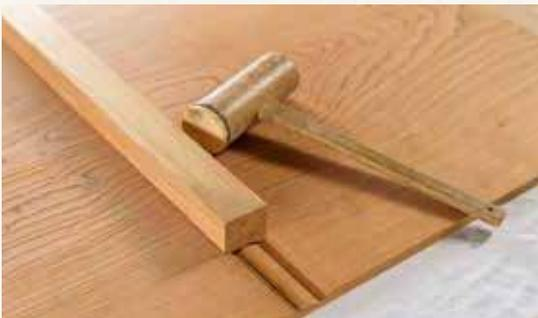
天板が反ることを防ぐため、蟻棧の技法を使います。ホゾの幅を微妙に変えることにより、接着剤などを使わずに、木と木を接合します。
