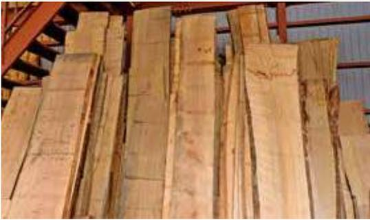
棧積みにより約1年天然乾燥します。中間期に「積み替え」をし乾燥を平均化します。
